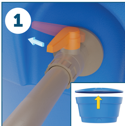
1 Feche o registro de alimentação, seque a caixa e retire a Torneira de Boia. Cierre la llave de paso general, vacíe el tanque y retire la Válvula de Flotador.
