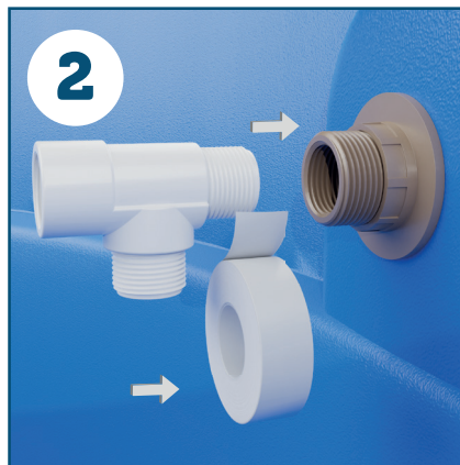
2 Aplique fita veda rosca na extremidade macho do Tee, em seguida rosqueie no adaptador para caixa d'água. (Use nipel de 1/2 com fita veda rosca para adaptador caixa d'água 20x1/2). Coloque cinta de teflón en el extremo macho de la conexión en T y a continuación enrósquela en el adaptador de la entrada de agua del tanque. (Use un niple de 1/2 con cinta de teflón como adaptador para tanque de agua de 20x1/2).
