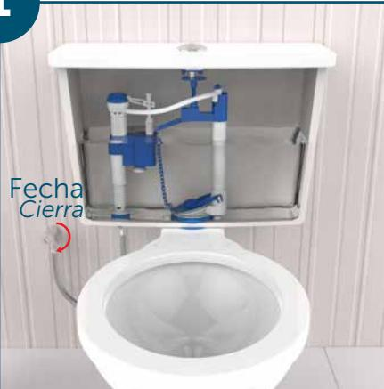
Feche a válvula de alimentação da caixa de descarga.
