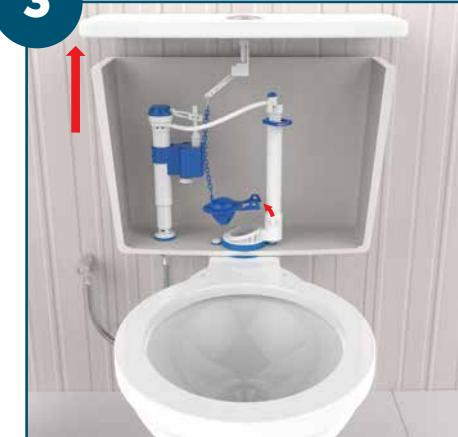
Remova a tampa da caixa de descarga, acionador e obturador (sapinho) com a corrente.
