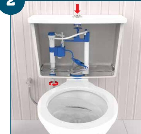
Esvazie a caixa de descarga (se necessário, limpe o interior da caixa).
