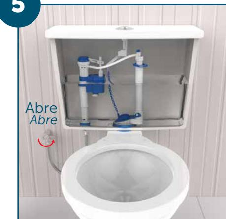
Encaixe a corrente na alavanca do acionador e reabra a válvula de alimentação da caixa de descarga.
