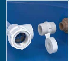
Se houver necessidade de utilizar o níquel, aplique fita veda rosca nos 2 lados do níquel e rosqueie no macho da saída d'água da caixa e corpo da válvula Neo Press conforme tamanho compatível.
