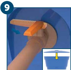
Recoloque a tampa da caixa d'água e reabra o registro de alimentação da caixa. **ATENÇÃO:** Após a instalação, verifique o funcionamento do conjunto.
