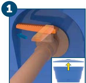
Feche o registro de alimentação da caixa d'água, esvazie-a completamente e remova a tampa.
